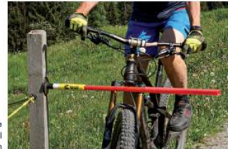
Aufstossen der Kippstange über Federgabel oder Rahmen
