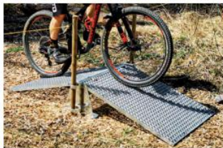
Gitterrampe, zusammengesetzt aus Stützbock und zwei Gitterrosten
