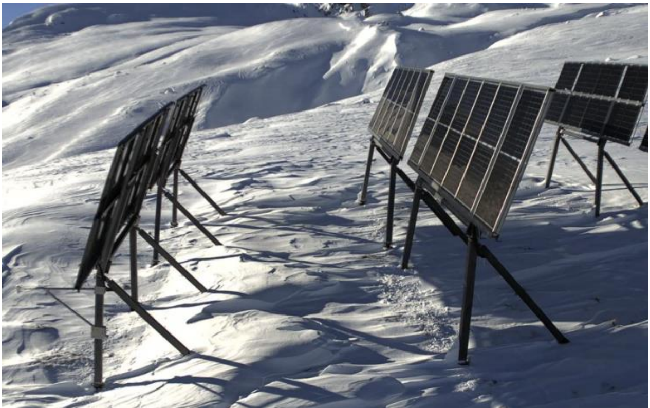
Die Testanlage wurde im November 2023 fertiggestellt. Die Abstände der Tische und die Höhe der Solarmodule entsprechen der geplanten Anlage.
